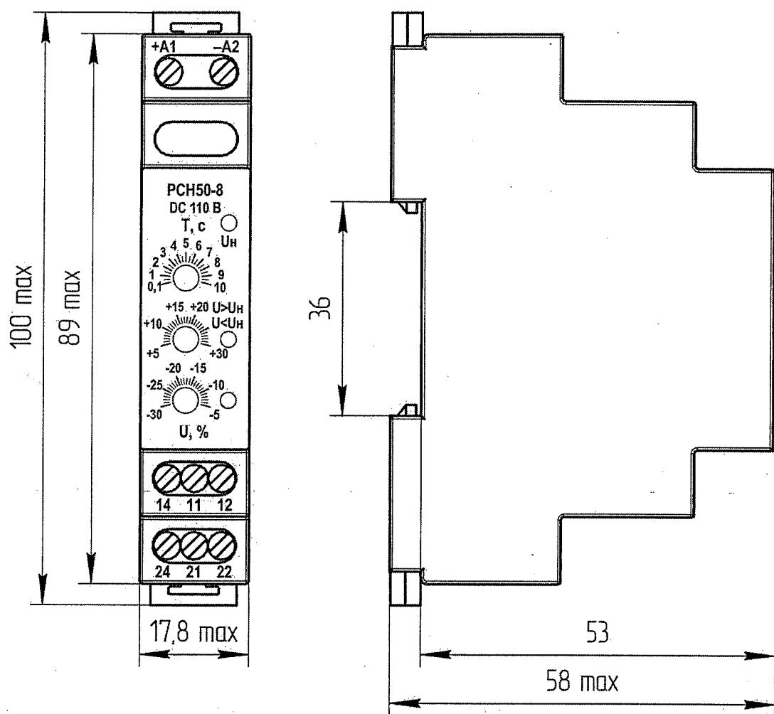
Рисунок Б.5 – Реле типа PCH50-8-XX-XXX4 и PCH50-9-XX-XXX4
