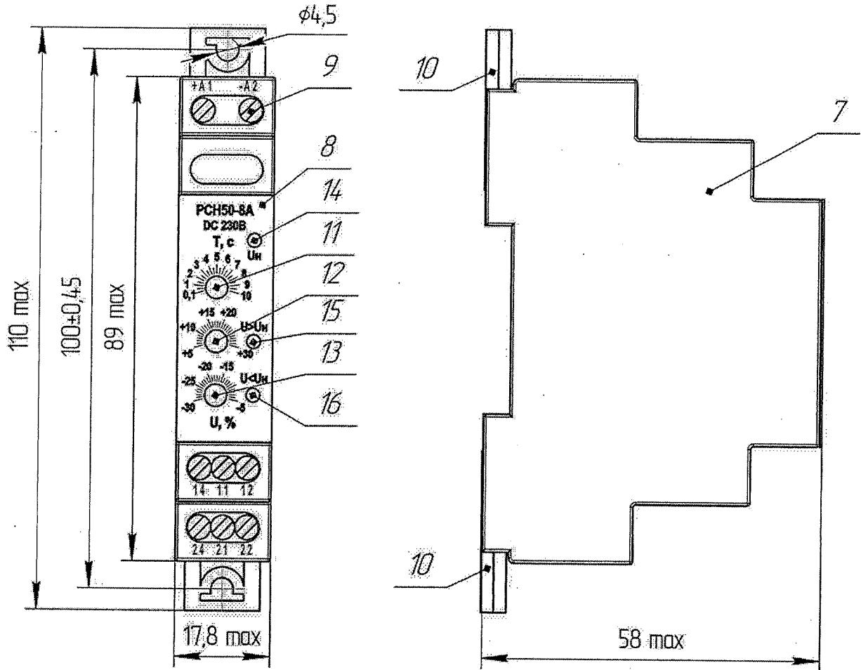
Рисунок Б.4 – Реле типа PCH50-8А-XX-XXX4 и PCH50-9А-XX-XXX4
