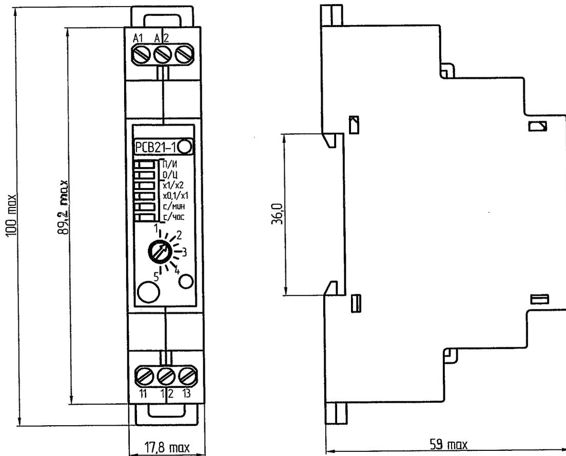
Рисунок Г.1 – Реле серии PCB21 для установки на DIN-рейку 35 мм
