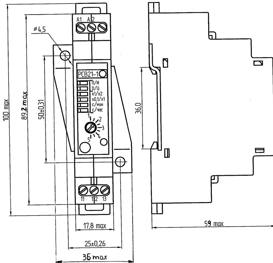
Рисунок Г.2 – Реле серии PCB21 для крепления на панель винтами
