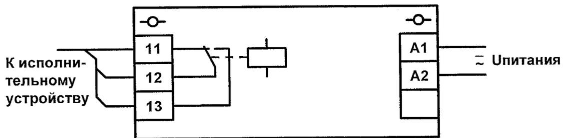
Рисунок В.1 – Схема подключения реле РСВ21-1
