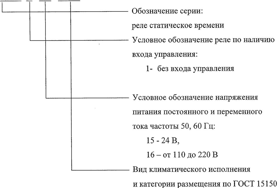
Пример записи обозначения реле на напряжение питания 24 В постоянного и переменного тока частоты 50 Гц без внешнего управляющего входа при его заказе и в документации другого изделия:
